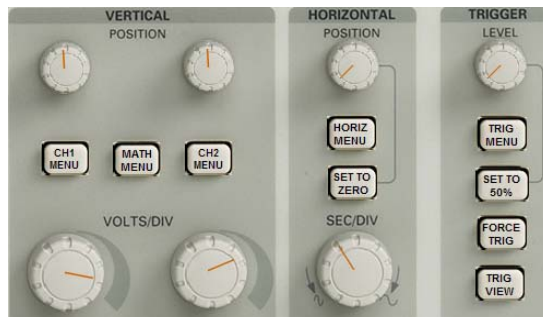
Slika 5: Podešavanje signala po vertikalnoj i horizontalnoj osi, i podešavanje nivoa trigerovanja
